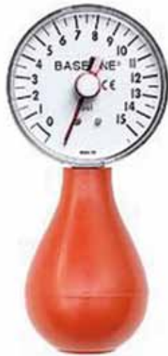
Abb. Handkraftmessgerät „Dynamometer“ – mit der üblichen Greifhand presst der Patient dreimalig den roten Ball zusammen. Die sich so ergebenden Messungen werden gemittelt und dann registriert.
